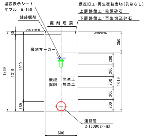
配管土工断面(17) 市道 車道As (高級) \phi 150 DCIP-GX 機械掘削 土被りH=1200
