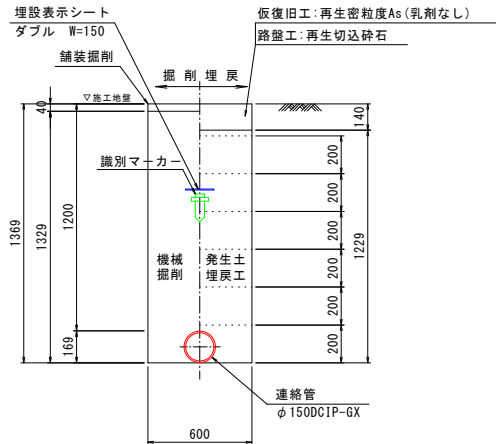
配管土工断面(16) 市道 歩道As \phi 150DCIP-GX 機械掘削 土被りH=1200
